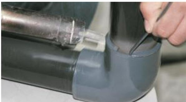
Метод сварки, является эффективным при изготовлении соединительных фитингов, изготовлении коллекторов и для любых соединительных операция. Метод приклеивания используется с целью повышения надежности соединения. Вместе с этим неправильно выполненная сварка становится причиной деформации трубопровода, деформации фитингов, рахода мест сварочных швов, образования сгоревших мест на деталях. По данной причине во время применения профессиональная достаточность и опыт имеют
