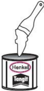
До приклеивания следует проверить густоту клея. Клей должен иметь консистенцию масла и не должен быть слишком текучим или иметь темный цвет. Клей должен использоваться только в целях слеивания труб. Нельзя использовать его для обеспечения герметичности и закрытия трещин.
